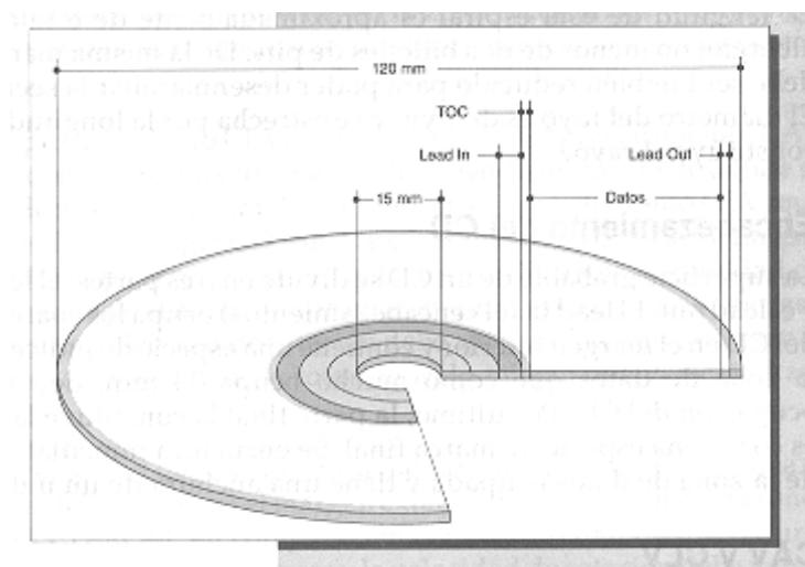
Es creencia muy común el pensar que un pozo corresponde a un valor binario y un llano al otro valor. Sin embargo, esto no es así, sino que los valores binarios son detectados por las *transiciones* de pozo a llano, y viceversa: una transición determina un 1 binario, mientras que la longitud de un pozo o un llano indica el número consecutivo de 0 binarios.
