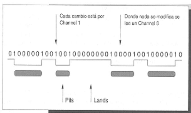
Además, los bits de información no son insertados "tal cual" en la pista del disco. En primer lugar, se utiliza una codificación conocida como modulación EFM (*Eighth to Fourteen Modulation*, o 'modulación ocho a catorce') cuya técnica consiste en igualar un bloque de ocho bits a uno de catorce, donde cada 1 binario debe estar separado (al menos) por dos 0 binarios.
