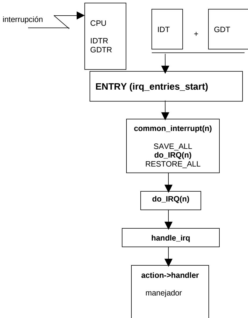
1. El decodificador de interrupciones recibe una interrupción (la patilla IRQ a nivel alto), este interrumpe a la CPU, que automáticamente mediante la entrada que corresponde a esta interrupción y con la ayuda de la IDT y la GDT nos lleva a **ENTRY (irq\_entries\_start)** dentro de arch/i386/kernel/entry.S, que salta a **common\_interrupt**.
