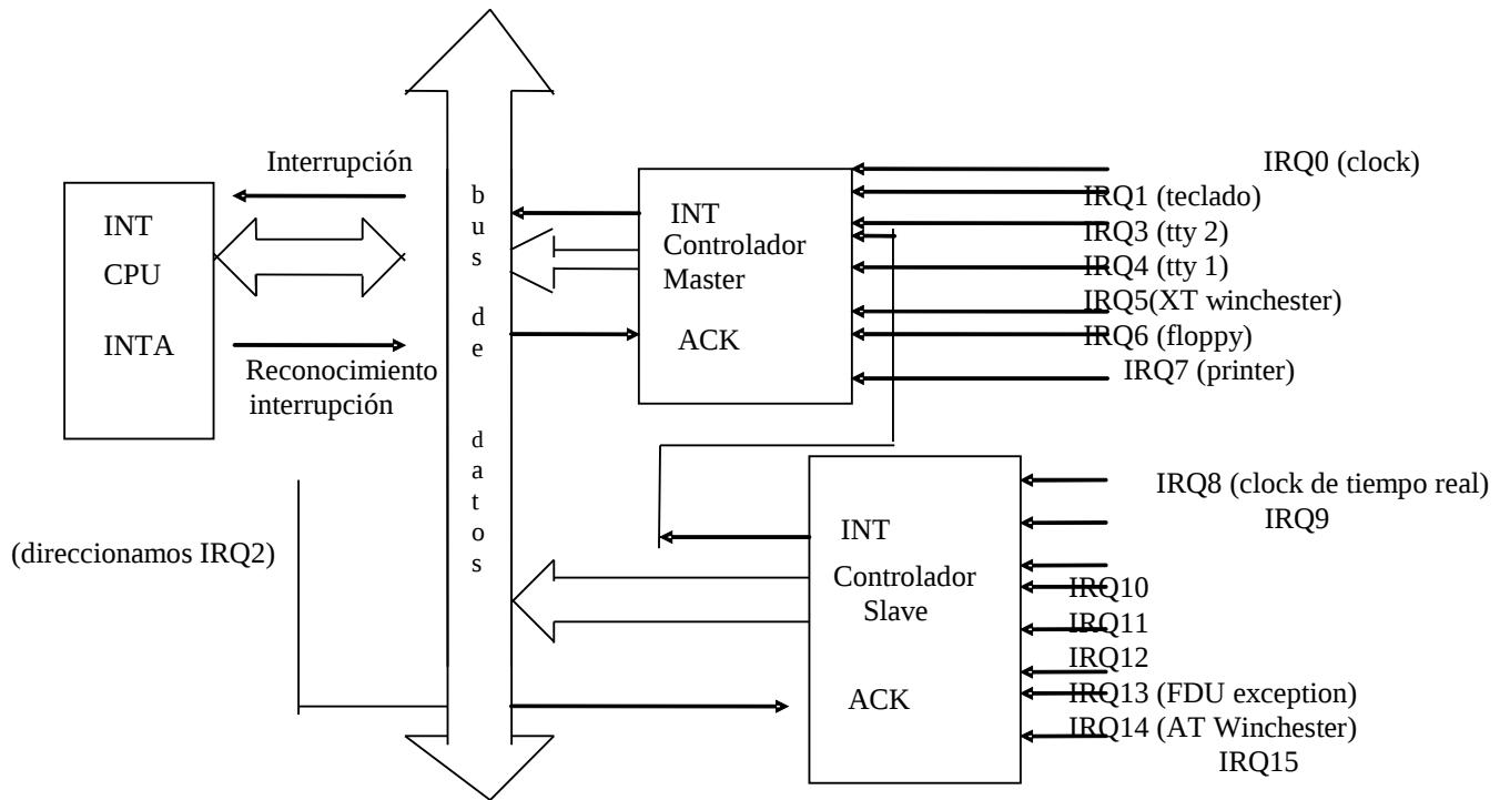
En la figura, se muestra dos controladores de 8 entradas, cada uno de ellos tiene una máscara y un registro de estatus de interrupción, un PIC1 y un PIC2. Los registros de máscara están en los direccionamientos 0x21 y 0xA1 y los registros del estatus están en 0x20 y 0xA0.
