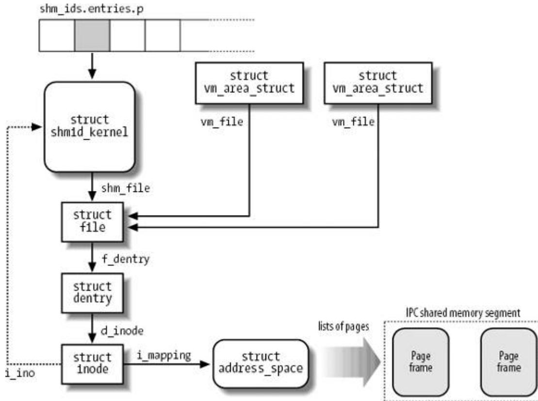
La variable *shm\_ids*, declarada en “ipc/shm.c” almacena una estructura de tipo *ipc\_ids* y que se utiliza para almacenar un array de estructuras *shm\_id\_kernel*, una por cada segmento de memoria compartido.
